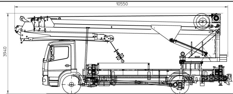
Der Böcker Autokran AK 44/4000 SPS ahy wird auf einem LKW 15 to. aufgebaut.
